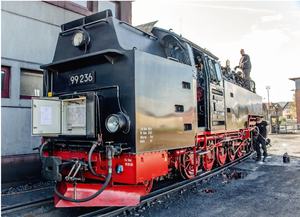
En las locomotoras de vapor del HSB, la electrónica del TrainCAS se encuentra detrás del tender. Una carga de batería es suficiente para siete días de funcionamiento.
