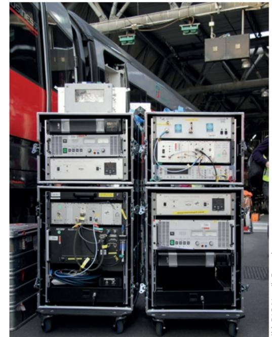
Der Channel Sounder besteht aus einer Sende- und einer Empfangseinheit. Der Empfänger zeigt, wie das Funksignal durch die Umgebung reflektiert wird.
